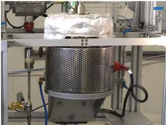
Ce nouvel équipement d'oxydation hydrothermale est plus volumineux et robuste que son prédécesseur. Il permettra, entre autres, à l'équipe d'explorer les utilisations de l'eau en mode supercritique.
