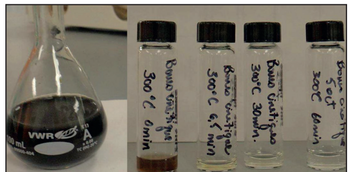
Les boues d'étangs aérés, avant et après traitement OHT
